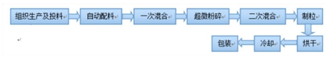
图1 颗粒水产饲料生产工艺流程图
